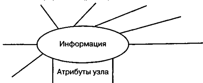
Рис. 1. Потенциальные (тонкие линии) и активные (толстые линии) связи некоторого узла информации. Активные связи соответствуют определенному типу атрибутов (напр., ключевых слов) данного узла.
